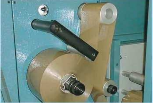
Pressore pneumatico con sensore fine bobina. Pneumatic pressure roller with roll-end detection. Presseur pneumatique avec détecteur de fin-bobine. Druckluftpresser mit Endspulesens.
