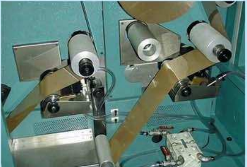
Stazione applicazione release, stazione applicazione primer e pompa per alimentazione in automatico del primer release. Stations to apply primer and release coats with pump for automatic feeding of the two chemicals. Postes pour application de primer et release avec pompe pour l'alimentation des deux produits. Stelle zur Anwendung von Primer und Release mit Pumpe zur automatischen Versorgung der 2 Produkten.
