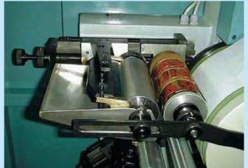
Stazioni di stampa con tamburo centrale riscaldato e termoregolato. Printing stations with heated central impression drum. Groupes d'impression avec tambour central chauffé. Druckstellen mit erwärmtem und wärmeergegtem Zentraltrommel.
