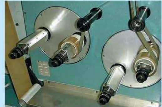
Torrette rotative con riavvolgitori da 3" (altri diametri opzionali) Twin turret rewind system with 3" mandrels (other optional diameters available) Groupe tournet de rebovinage pour mandrin 3" (autres diametres optionnels) Drehköpfe mit 3"-Aufwickler (andere wahlfreie Durchmesser).
